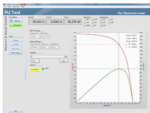
Die MPPT-Funktion erfasst Messdaten von einem angeschlossenen Solarpanel. Dabei wechselt die Funktion kontinuierlich zwischen dem MPPT-Vorgang und einem Sweep-Vorgang. Während des MPPT-Vorgangs regelt die Last den globalen MPP, der bei der Sweep-Funktion gefunden wurde.
