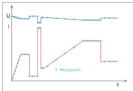
Durch List-Funktion erzeugte Kurvenform mit synchronisierter Messwertaufnahme von Zeit, Spannung und Strom
