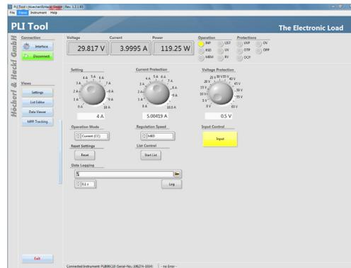
Das PLI Tool ist eine Steuersoftware für elektronische Lasten der Serie PLI. Durch eine Navigationsleiste kann zwischen den einzelnen Anwendungen umgeschaltet werden. Im Hauptmenü (Setting) werden die wichtigsten Geräteeinstellungen vorgenommen. Eine Messwert- und Statusleiste informiert über den aktuellen Gerätezustand. Die Datenlogger-Funktion kann konfiguriert und aktiviert werden.
