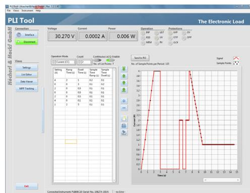
Mit dem List Editor werden tabellarisch Setting-Werte für Strom, Spannung, Leistung oder Widerstand, die dazugehörigen Anstiegs- und Abfallzeiten und die Verweilzeiten generiert. Zusätzlich kann für jede Anstiegs- und Verweildauer eine eigene zu den Settingwerten synchrone Messrate für Strom und Spannung angegeben werden.
